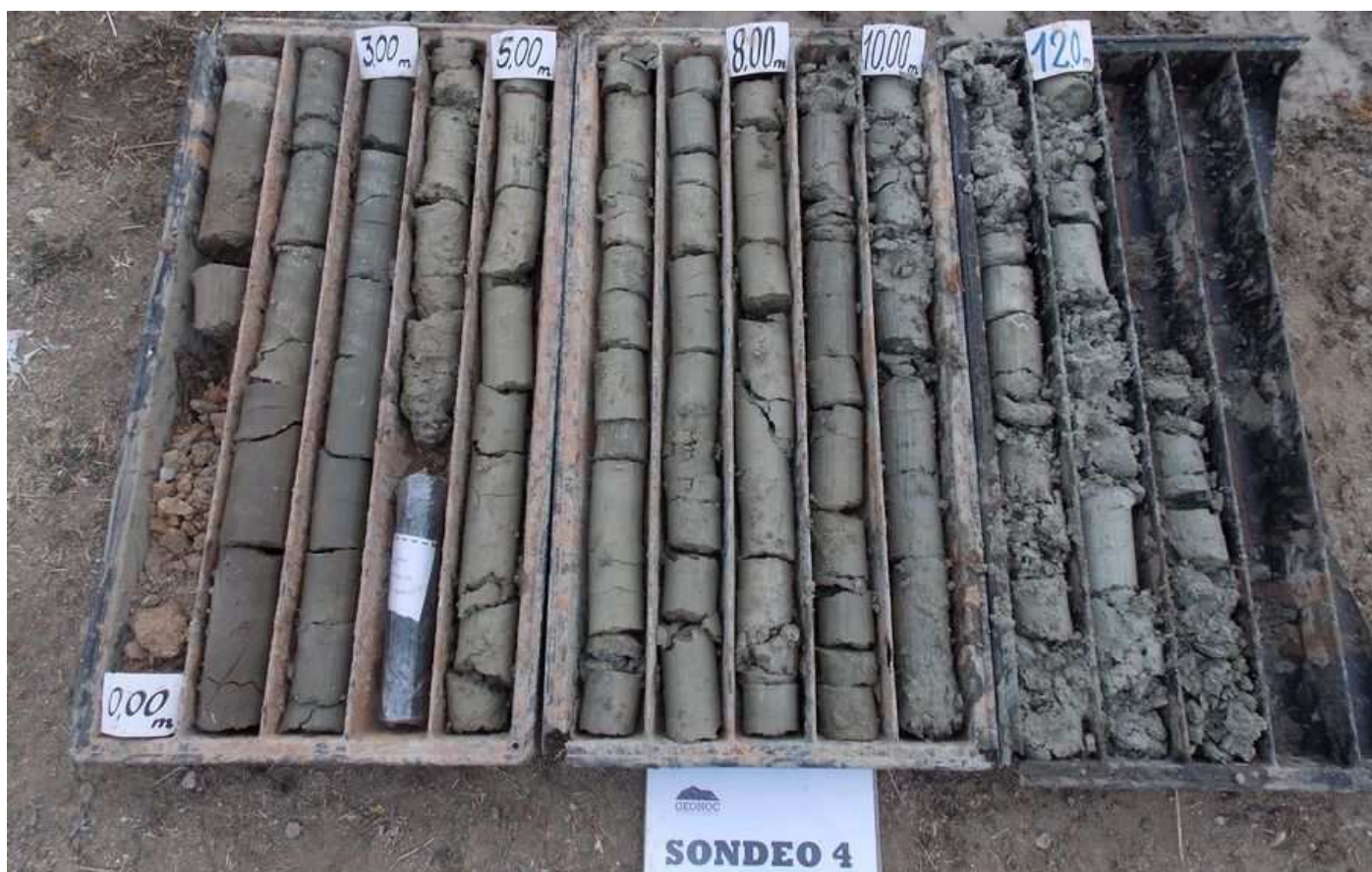
FOTOGRAFIA 8: Vista de los testigos del sondeo 4.
